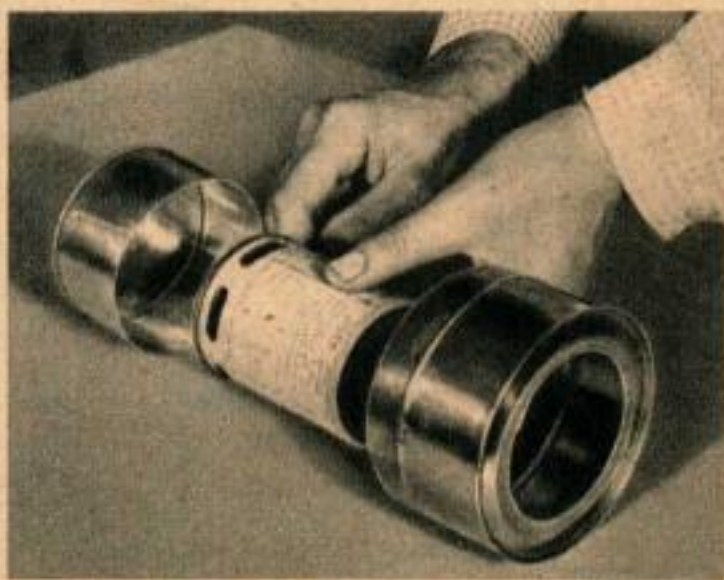
Voici 3 des 4 pièces constituant le ventilateur; elles sont placées dans l'ordre définitif. Les ouvertures allongées laissent passer l'air mais non la lumière.
