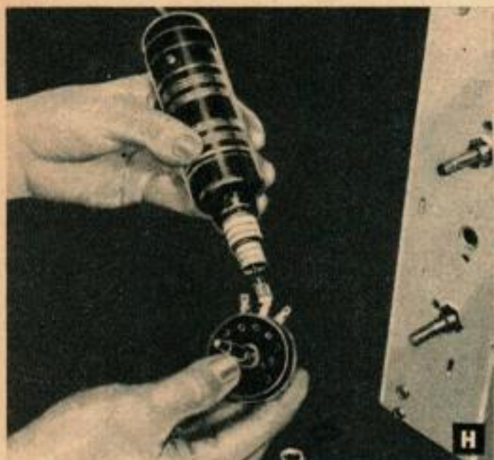
Photo H. — Un petit outil à actionner les fraises ou les meules est très utile sur un établi de dépanneur. Il permet d'enlever la vieille soudure dans les œils des appareils (volume-contrôle dans le cas de la photo). Il est également très utile pour décaper les fils et les pièces avant de faire des soudures. Pour faire les contacts sur la masse du châssis, il faut décaper la tôle de ce dernier avant la soudure et la meule s'y prête bien.
