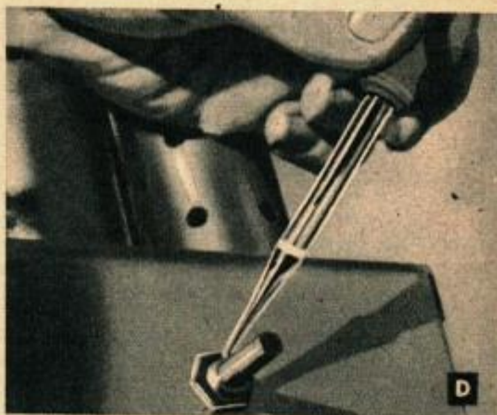
Photo C. — Les blindages des selfs sous l'action des secousses dans les transports sont parfois desserrés et il faut les vérifier si l'on entend des bruits provenant de vibrations. Mettre une rondelle élastique sous la tête de la vis de fixation et bien serrer cette dernière. Des vibrations analogues se décèlent parfois dans les vis et les ferrures de montage des transformateurs, des selfs, etc.
