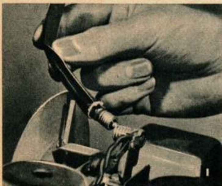
Photo I. — Lorsque les doigts ne peuvent accéder facilement à certains endroits peu accessibles tels que les ampoules éclairant les cadrans d'accord, utiliser un morceau de tube de fibre dont le diamètre est légèrement inférieur à celui de l'ampoule afin que cette dernière puisse s'encastrer dedans, ce qui permet un dévissage et un revissage faciles. On peut utiliser un tuyau de caoutchouc mais le tube de fibre est plus rigide, tout en restant suffisamment maniable.
