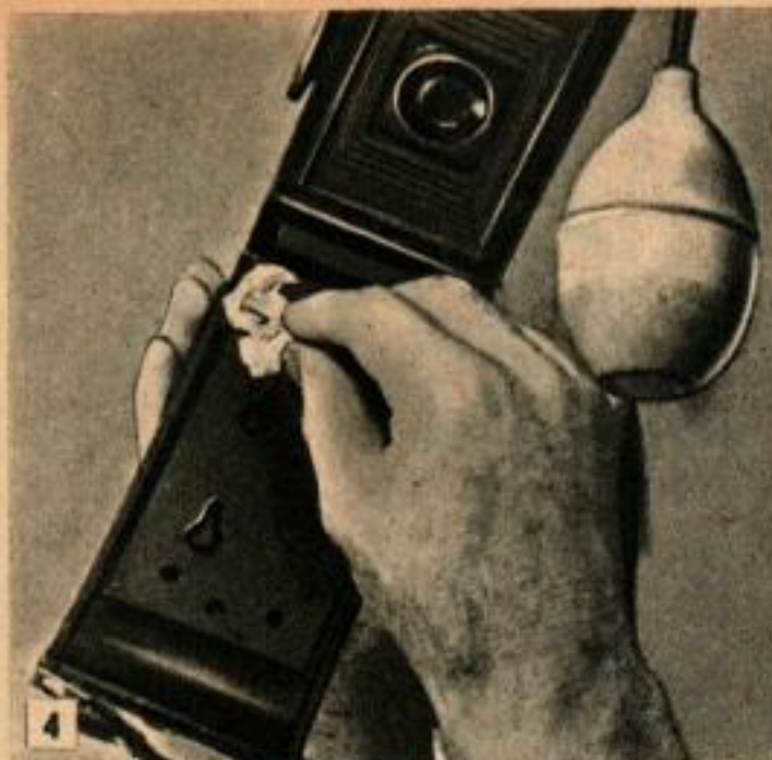
4 Pour nettoyer l'intérieur de l'appareil, utiliser une étoffe humectée de tétrachlorure de carbone.
