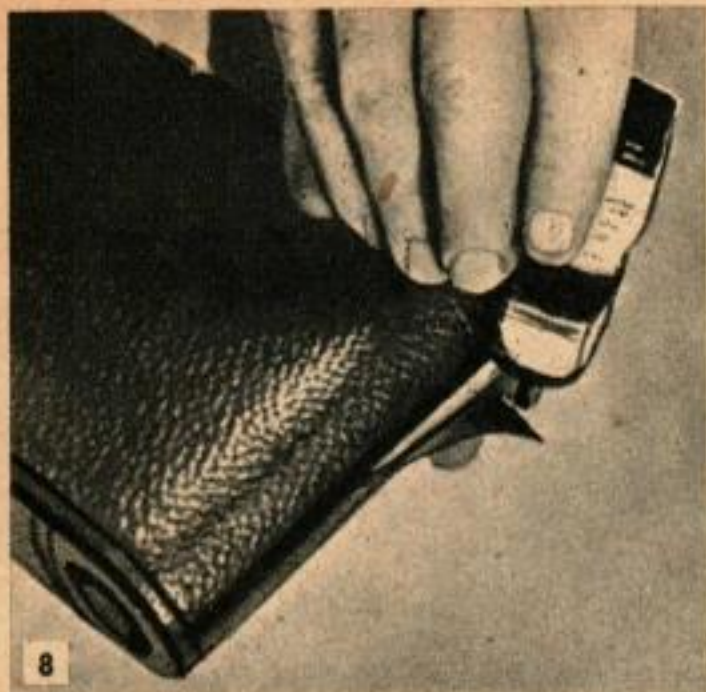
8 Le maroquin déchiré est recollé avec un peu de colle cellulosique. On commence par recouvrir de colle les deux surfaces et on les presse ensuite l'une contre l'autre.
