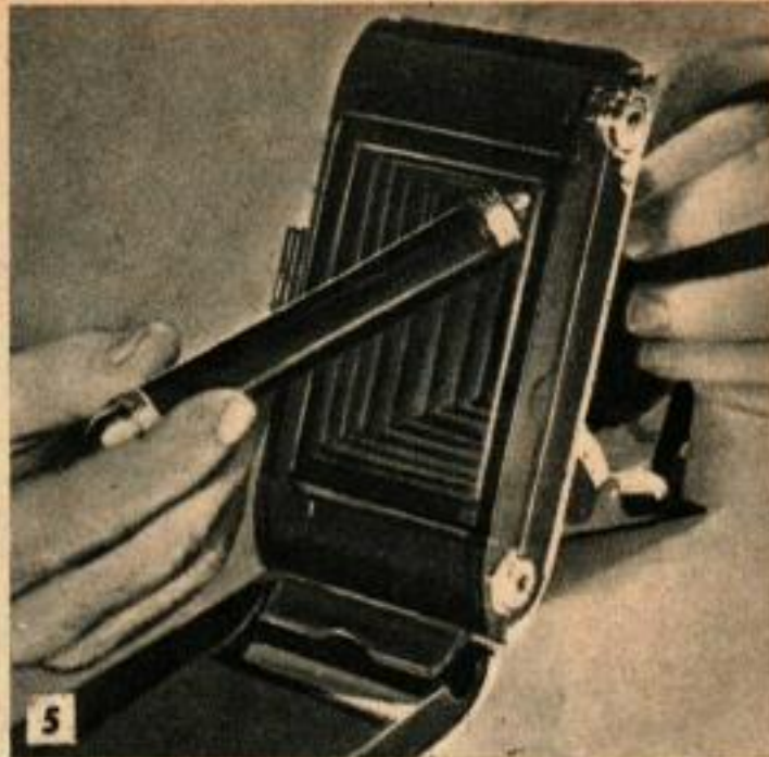
5 Pour localiser une fuite de lumière, mettre une lampe de poche dans les angles du soufflet et regarder de l'extérieur.
