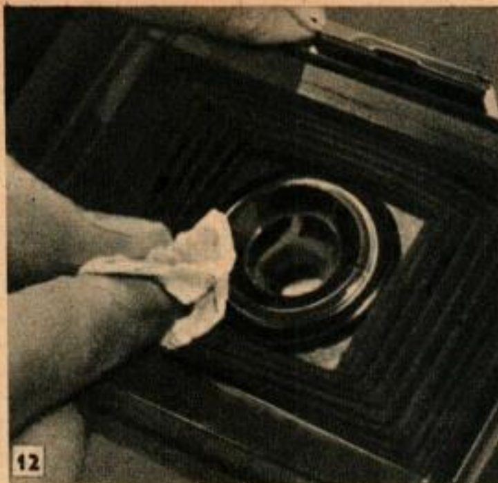
12 Pour nettoyer la partie intérieure de l'objectif, enlevez la partie arrière de l'appareil et comprimez le soufflet.
