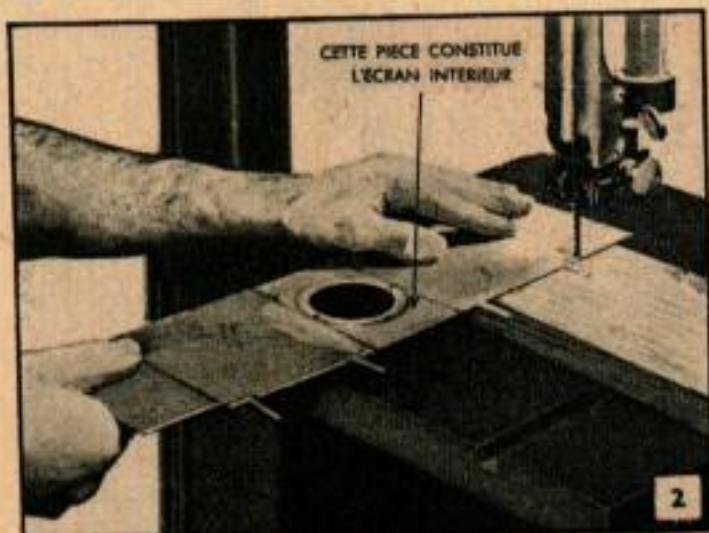
Les parties métalliques sont découpées à la scie.
