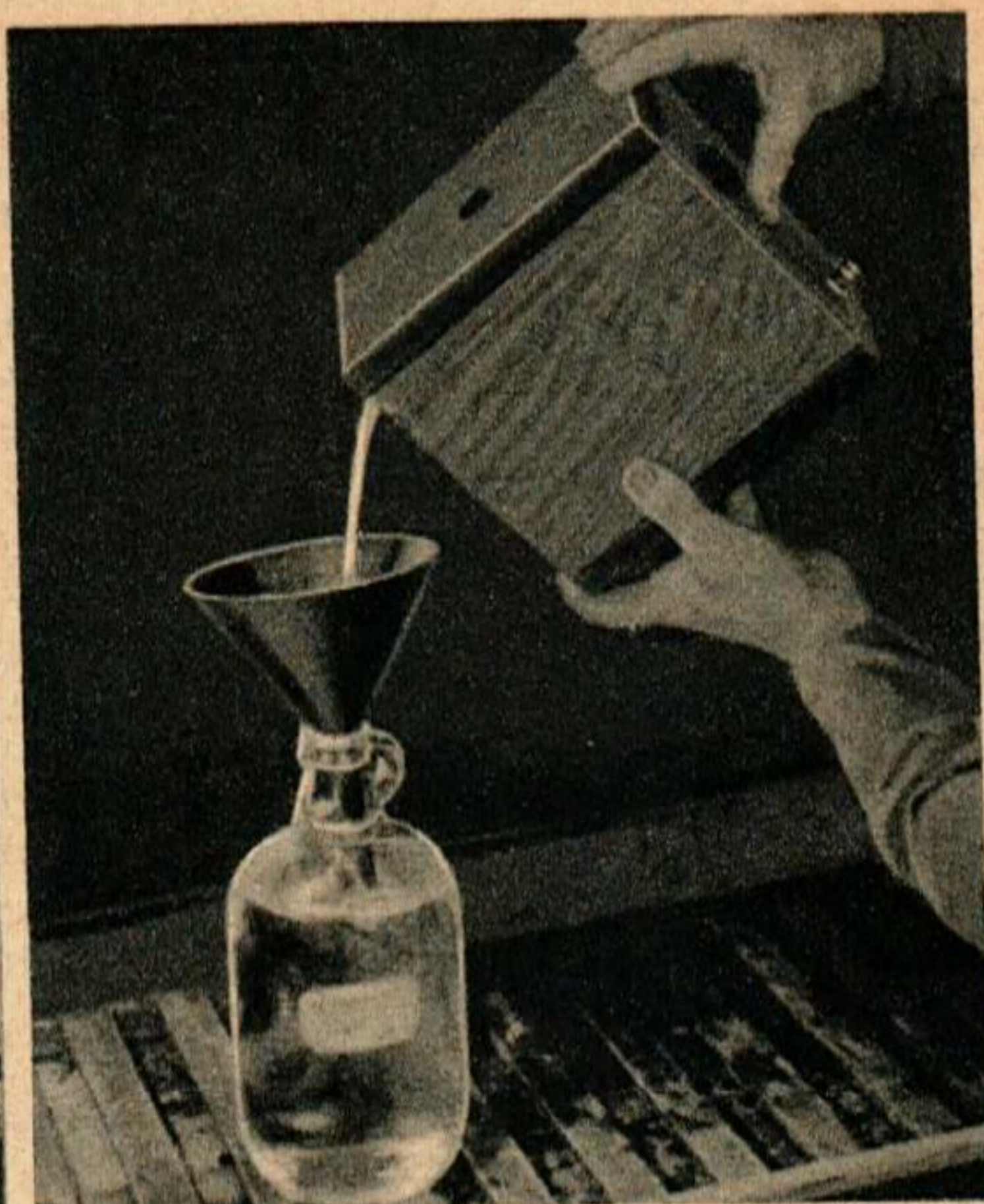
A gauche, lorsqu'on charge la cuve, utiliser l'éclairage de sécurité et remplir de révélateur. Agiter avant l'emploi. A droite, en vidant la cuve faire attention à ne pas laisser échapper le couvercle. Mettre un joint en caoutchouc pour éviter cet accident.
