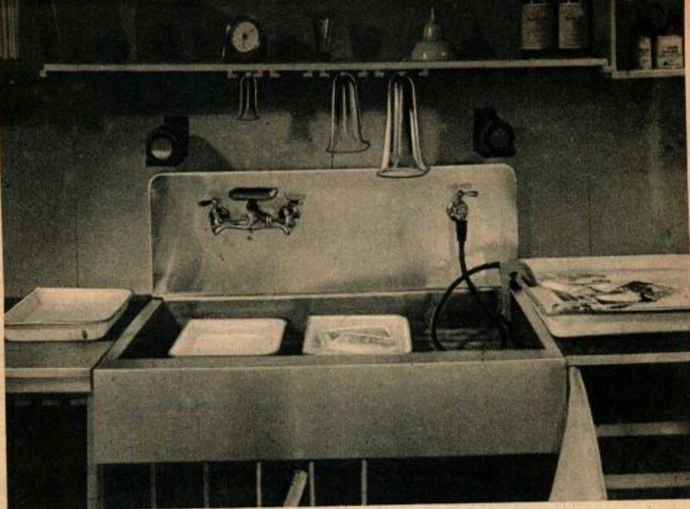
Voici la partie du laboratoire où se font les travaux par voie humide, elle est située tout naturellement au voisinage de l'évier. Les épreuves se déplacent de gauche à droite dans l'ordre: développement, rinçage et fixage.
