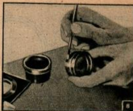
Si les indications inscrites sur la monture de l'objectif ne sont pas lisibles, vous pouvez les refaire avec de la peinture blanche.
