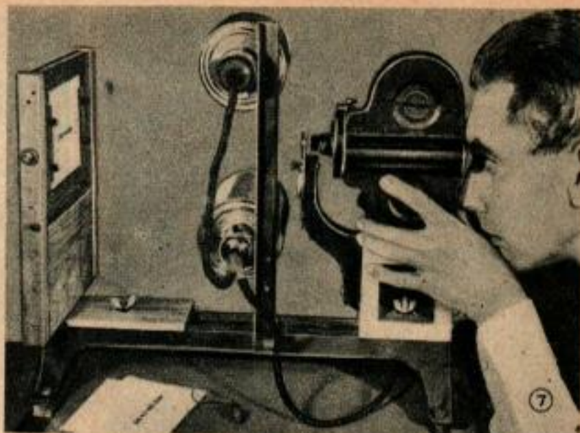
La mise au point se fait avec le viseur
