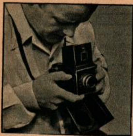
Les appareils du type "Réflex" ci-dessus, utilisent pour la mise au point un verre dépoli, alors que les appareils munis de télémètres sont réglés en superposant deux images identiques
