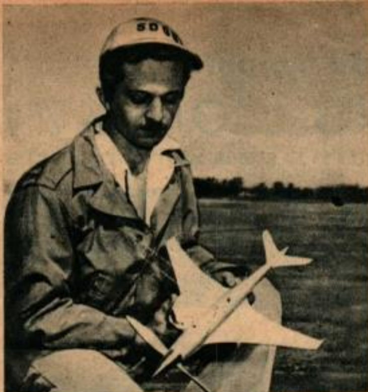
«Fusée folle» tel est le nom donné par Joe Havlik de San Diego à son «supersonique» de course, classe D. Le moteur est monté dans l'aile droite; l'empennage horizontal est en flèche et il n'y a pas d'empennage vertical.
