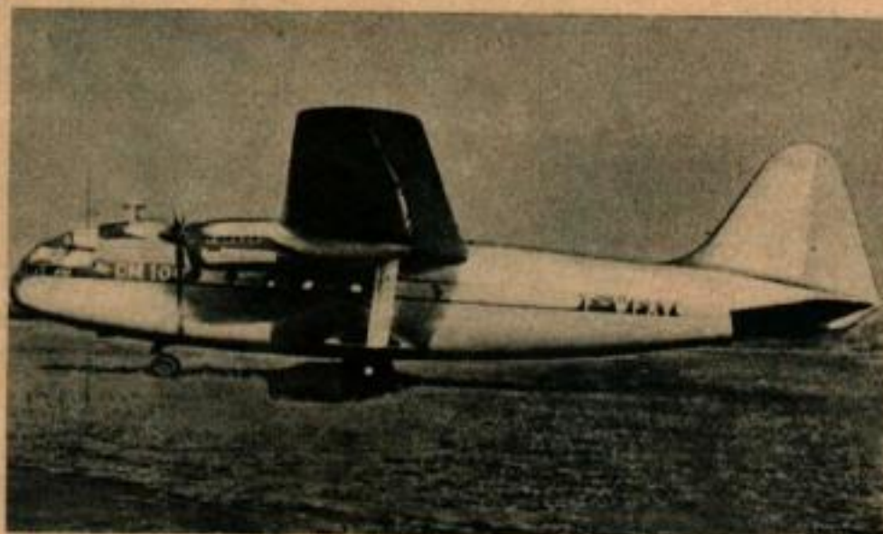
Transport de 1.200 kg de charge commerciale. 2 moteurs Renault, envergure 26,7 m, longueur 17,9 m. Poids total : 7.300 kg. Vitesse de croisière à 2.000 m : 252 km/h. Rayon d'action : 1.000 km.
