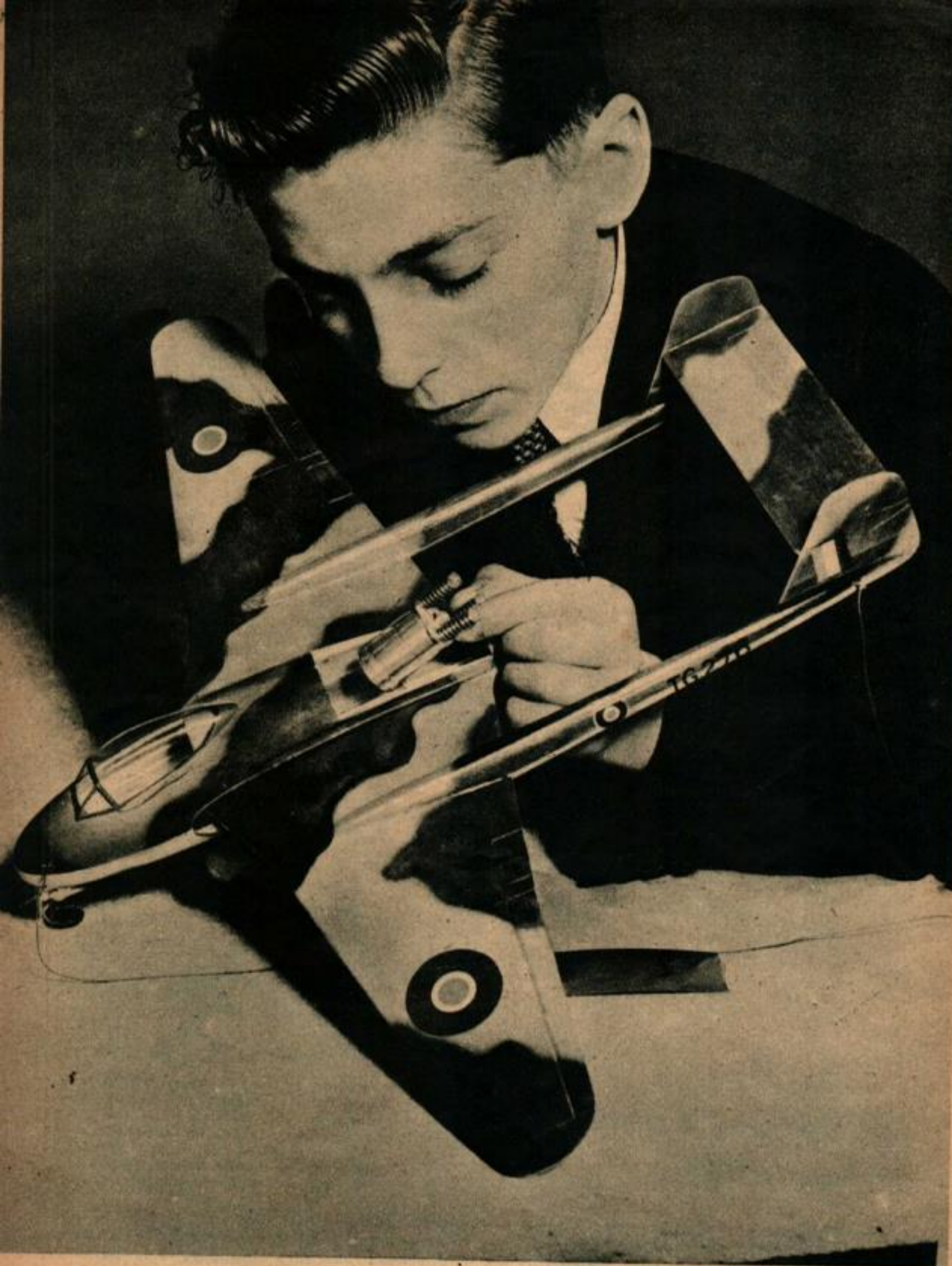
« JETEX », le plus petit moteur à réaction du monde pèse moins de 30 grammes. Il a environ 2 cm de diamètre. Il fournit une puissance suffisante pour faire voler des modèles réduits ayant jusqu'à 60 cm d'envergure.
