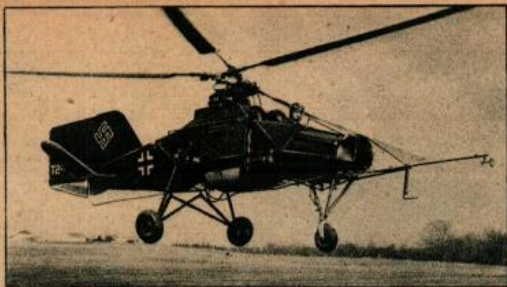
L'hélicoptère allemand Flettner 282 (au-dessus) annule le couple au moyen de 2 rotors voisins inclinés de telle sorte que les 2 axes fassent un angle de 24 deg. Ci-dessous, un 5 places Bell XR-12 obtient le même résultat avec un rotor de queue.
