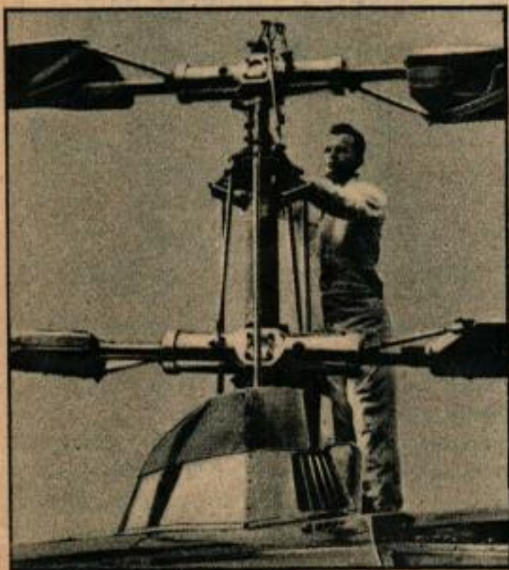
Les hélicoptères du centre et de gauche réagissent contre le couple de l'hélice au moyen d'un roto à l'arrière, alors que le modèle coaxial à droite utilise deux rotors horizontaux. Au-dessous et à gauche on vérifie le mécanisme qui fait varier l'angle d'attaque des pales du rotor. À droite, quand on a enlevé le revêtement en aluminium, l'hélicoptère est un labyrinthe d'appareils.
