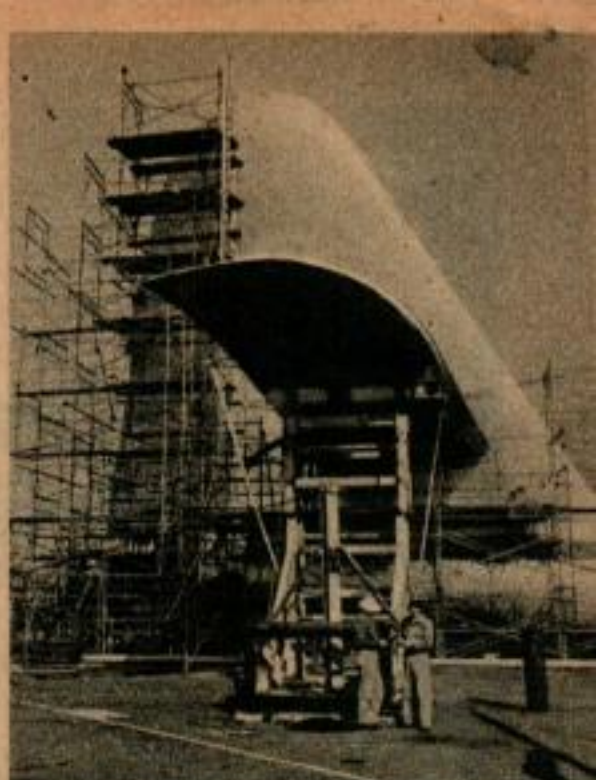
Ci-dessus, on installe l'empennage vertical, hauteur 16 m.
