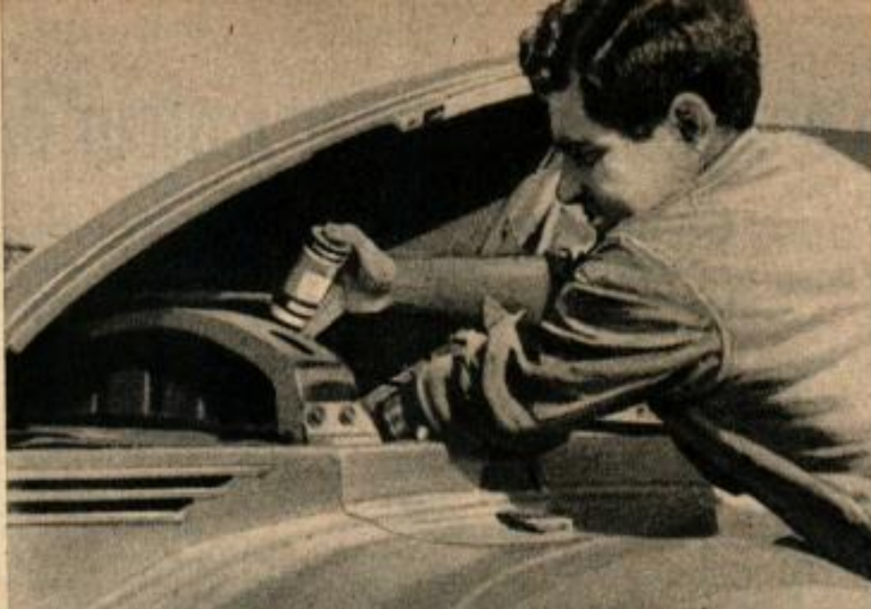
14 EMPLOI DE PRODUITS SPECIAUX POUR NETTOYAGE DES RADIATEURS
