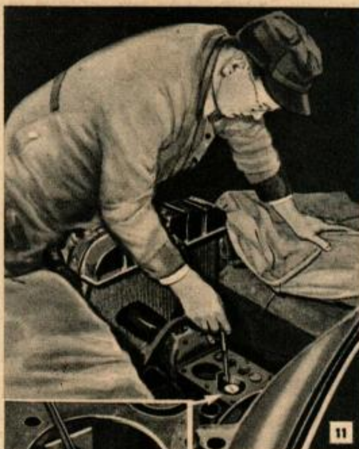
Examen du cylindre pour trouver le faux rond et la conicité au moyen d'un comparateur.
