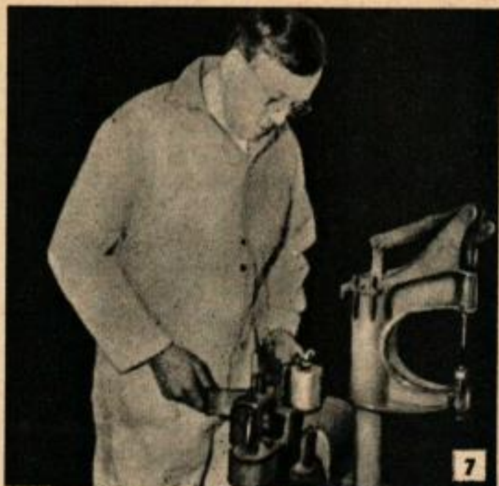
Après avoir regarni les sabots, les meuler au diamètre exact du tambour pour éviter du broutage.
