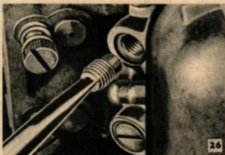
Lorsqu'on démonte les gicleurs du carburateur, il est bon de meuler les côtés de la lame du tournevis afin de ne pas endommager les filets du taraudage.
