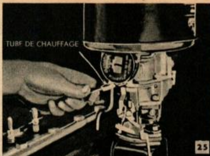
Enlever le tube de chauffage qui commande le bilame et souffler avec de l'air comprimé pour enlever les dépôts carbonneux.
