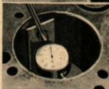
Examen du cylindre pour trouver le faux rond et la conicité au moyen d'un comparateur.
