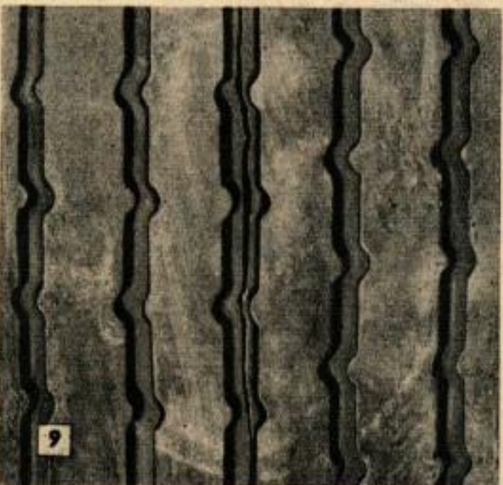
Un gonflage toujours excessif donne des ruptures du genre ci-dessus. Il est très dangereux de conduire une voiture munie de tels pneus surtout si la route est encombrée.
