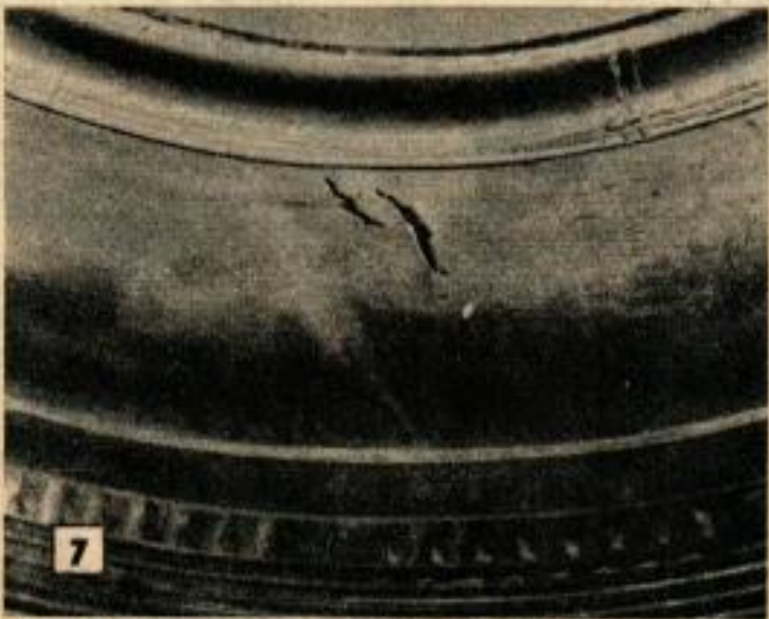
Dans les vieux pneus, les fissures se produisent aussi sur l'extérieur de l'enveloppe. Un pli excessif entraîne un pincement de la chambre à air, qui provoque une rupture, immédiate ou différée, mais qui se produit finalement.
