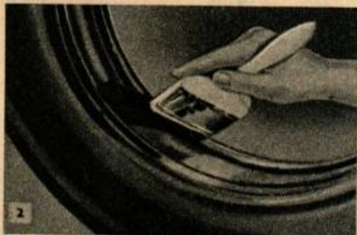
2 Avant de remettre le pneu en place, graisser les bords du caoutchouc avec une huile végétale (ne pas employer de graisse ou d'huile minérale).
