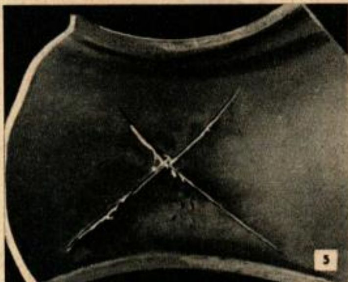
Une petite rupture due à un choc dur s'agrandit rapidement et donne une déchirure en croix comme ci-dessus. Le pneu se dégonfle continuellement.
