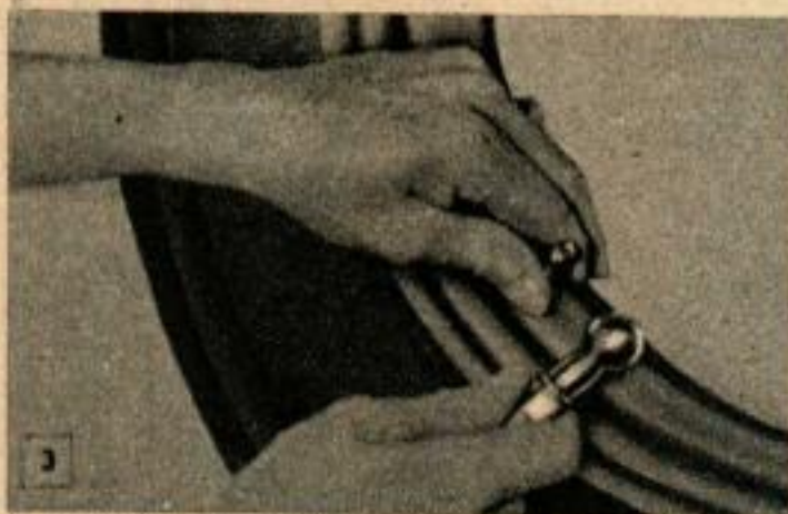
3 Après avoir remonté le pneu sur la jante, gonfler pour que le bord du pneu adhère fortement sur la jante.
