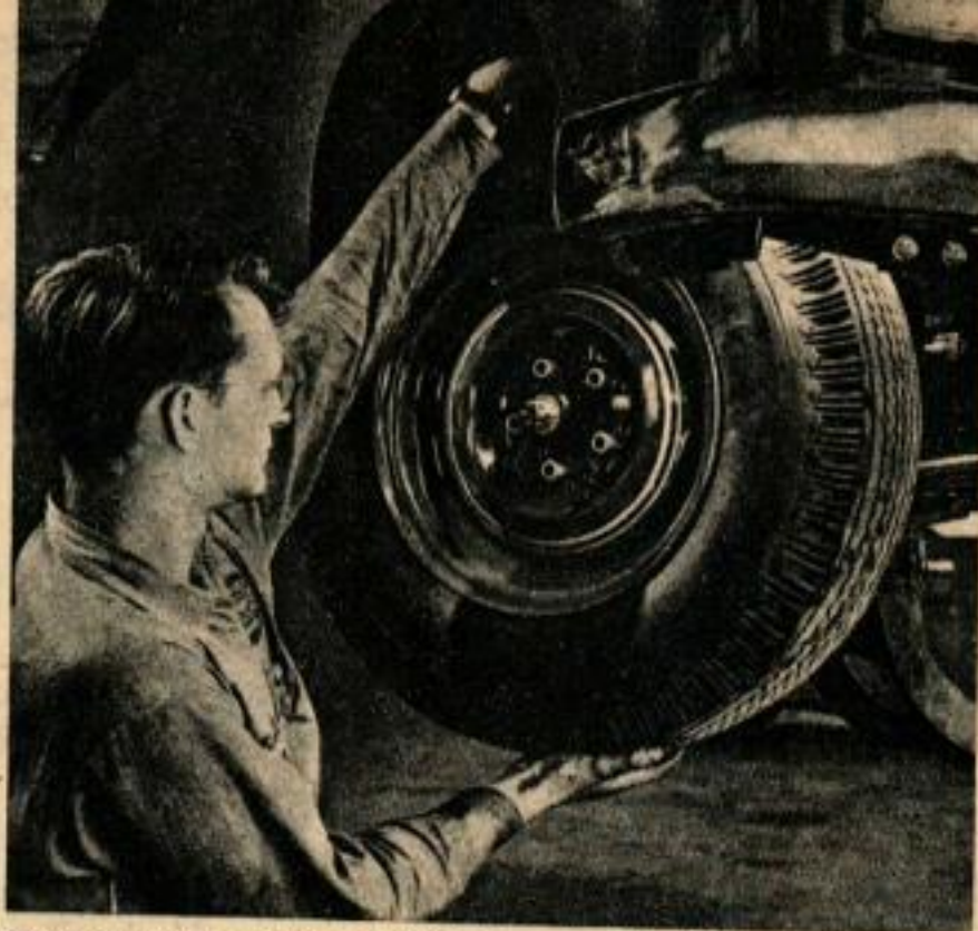
Essai de jeu du roulement d'une roue avant en faisant basculer cette dernière. Ne pas confondre ce déplacement avec celui dû au déplacement autour du pivot incliné.
