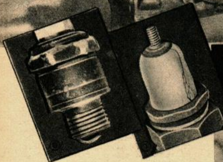
La bougie de gauche a été endommagée par l'emploi d'une clé trop large qui a glissé et brisé la porcelaine (à droite).
