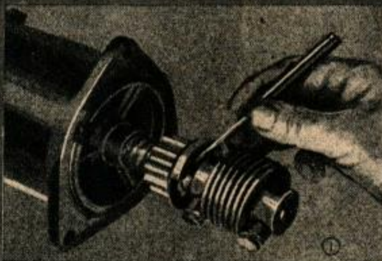
Lorsqu'on examine un démarreur qui ne marche pas bien, s'assurer que la broche poussée par un petit ressort (à l'extrémité du tournevis) n'est pas collée par la poussière et la carbonée sur l'épaulement de l'arbre, ce qui empêcherait la prise de contact des dents du pignon du démarreur avec celles du volant du moteur.
