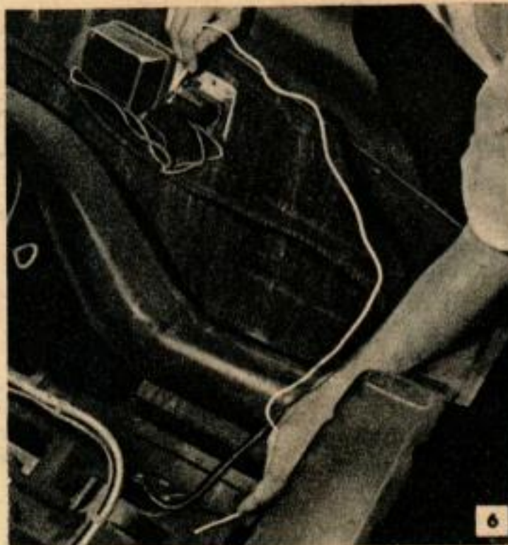
En réunissant la masse du régulateur et celle de la dynamo, on vérifie s'il y a ou non une mauvaise mise à la masse.
