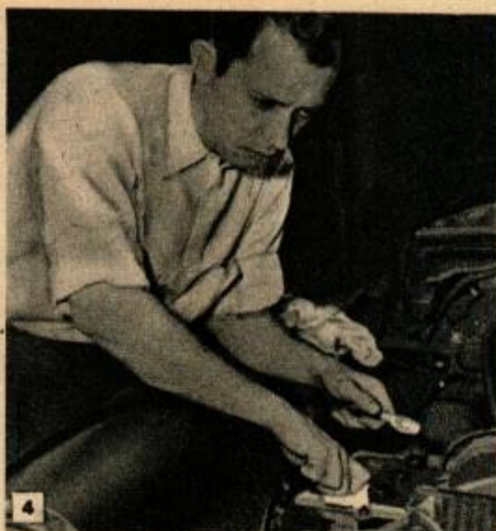
4 S'assurer que les bornes et les fils de la batterie ne sont pas endommagés. Décaper avec du papier de verre et du bicarbonate de sodium.
