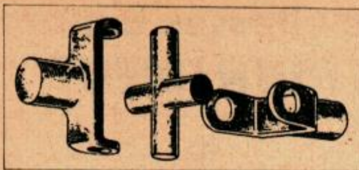
Fig. 3 — Exemple de joint de cardan employé sur les arbres de commande. Les joints actuels utilisent quatre roulements à aiguilles.
