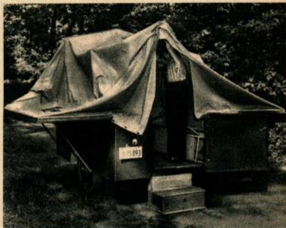
Ci-dessus, on ouvre de l'intérieur la tente en agissant sur la charpente tubulaire qui sert de carcasse. Le petit escalier amovible sous la porte sert de point d'appui pour éviter le basculement du véhicule. Ci-dessous, la toile de tente est agrafée sur les boutons qui sont placés à l'avant de la caisse.
