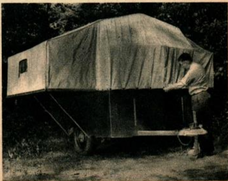
Ci-dessus, on ouvre de l'intérieur la tente en agissant sur la charpente tubulaire qui sert de carcasse. Le petit escalier amovible sous la porte sert de point d'appui pour éviter le basculement du véhicule. Ci-dessous, la toile de tente est agrafée sur les boutons qui sont placés à l'avant de la caisse.
