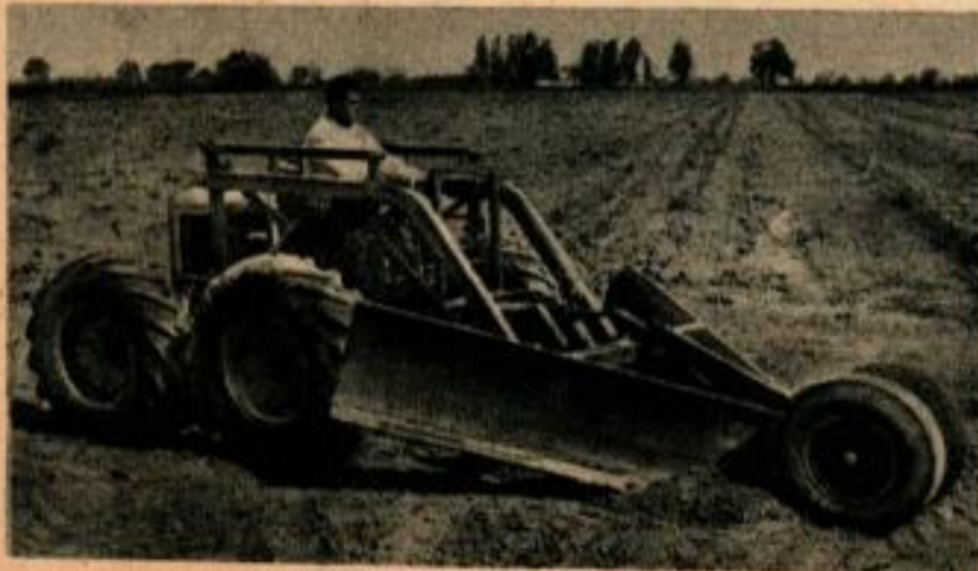
Voici un autre appareil construit à la ferme: il s'agit d'une fourche hydraulique qui peut soulever 455 kg (1 000 lbs) à une hauteur de 2,70 m (9 ft.). Sur la photo, on le voit utilisé au transport de ruches vers un champ d'alfa. Ci-dessous, une machine à creuser, conçue par son propriétaire, est munie de deux commandes hydrauliques permettant de lever, d'abaisser ou d'incliner la lame.
