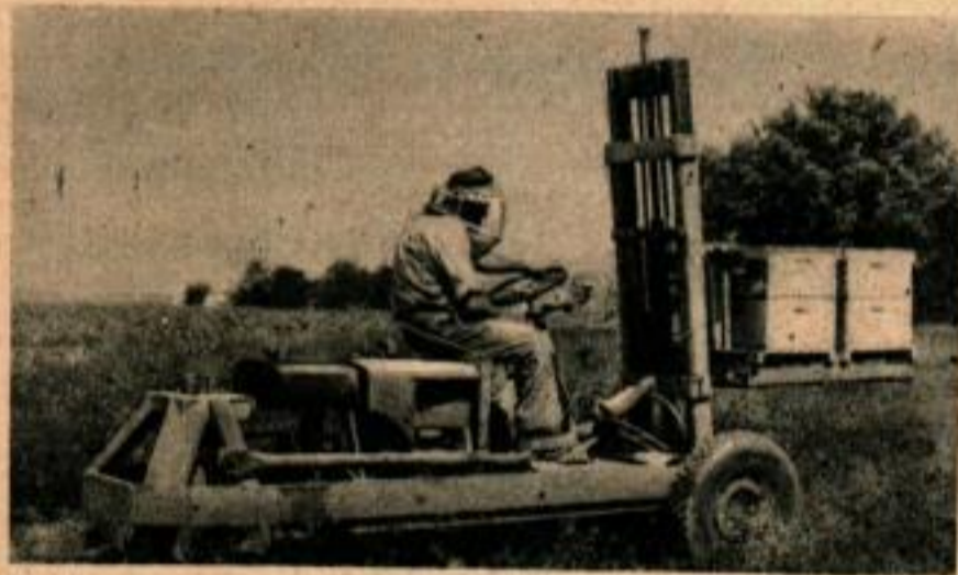
Voici un autre appareil construit à la ferme: il s'agit d'une fourche hydraulique qui peut soulever 455 kg (1 000 lbs) à une hauteur de 2,70 m (9 ft.). Sur la photo, on le voit utilisé au transport de ruches vers un champ d'alfa. Ci-dessous, une machine à creuser, conçue par son propriétaire, est munie de deux commandes hydrauliques permettant de lever, d'abaisser ou d'incliner la lame.
