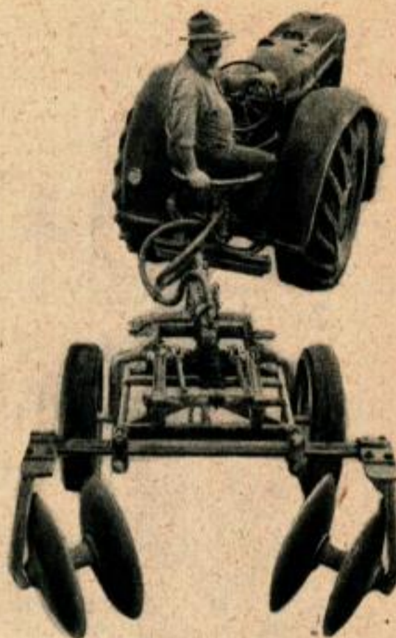
Une remorque équipée d'un levier hydraulique transporte les outils et règle la profondeur à laquelle ils travaillent.
