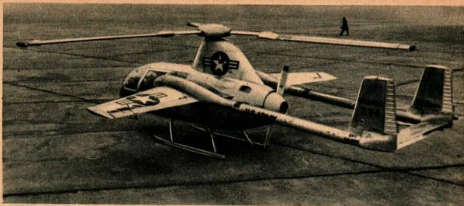
Le premier convertible militaire américain est le XV-1, construit par Mac Donnel. Il est actionné par une hélice propulsive et des rotors orientables à turbo-réacteurs.
