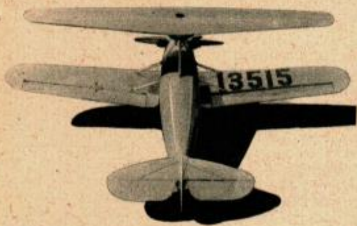
Le rotor libre essayé en 1937 par Herrick ouvrit la voie aux rotors à moteur. Cet avion pouvait décoller comme un biplan et atterrir comme un autogyre.
