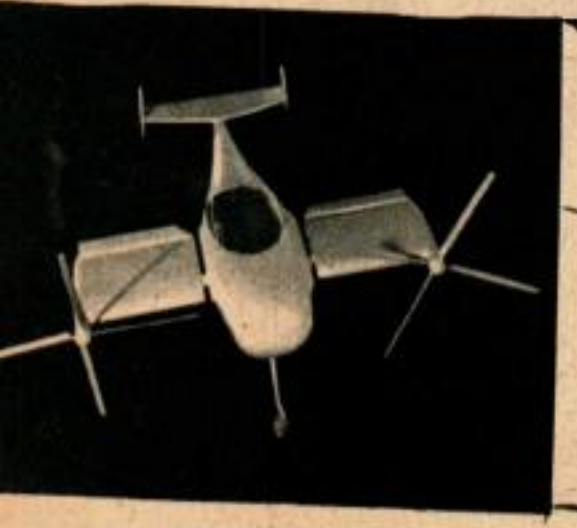
Un seul moteur, placé à l'arrière, actionne les rotors sur l'aile pivotante de ce Convertawings.
