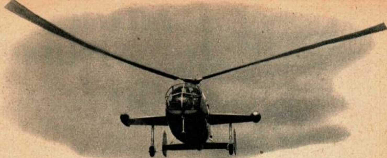
Photo Flying Magazine Le prototype volant de la British Fairey Gyrodyne est équipé avec deux moteurs à hélices à l'extrémité de petites ailes pour la marche en avant et un rotor à trois pales.
