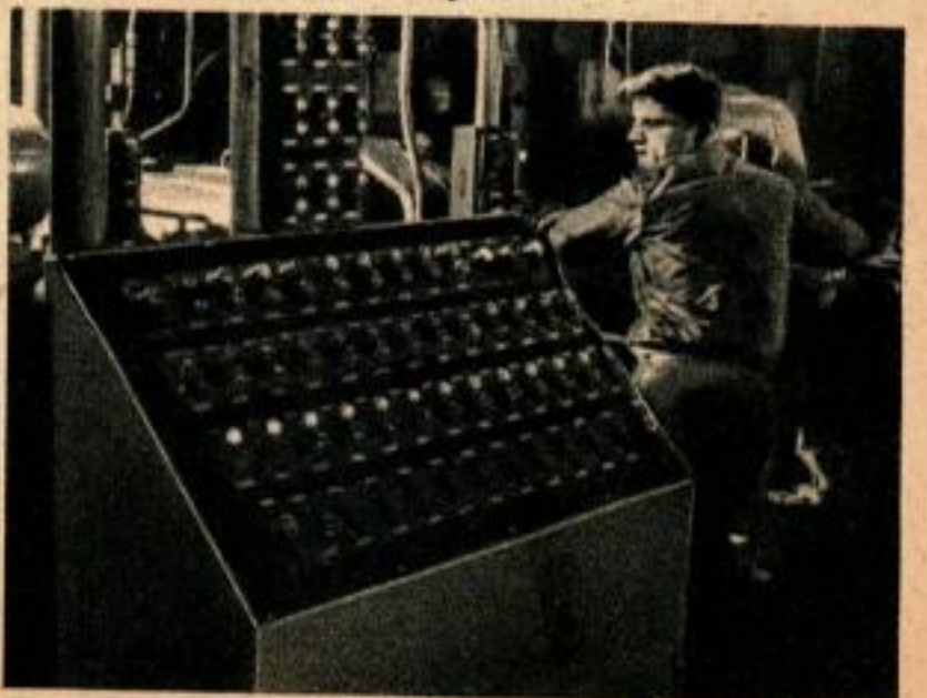
Un ouvrier observe, sur le tableau de contrôle, l'allumage des lampes indiquant la marche des pièces de fonte sur une perceuse.
