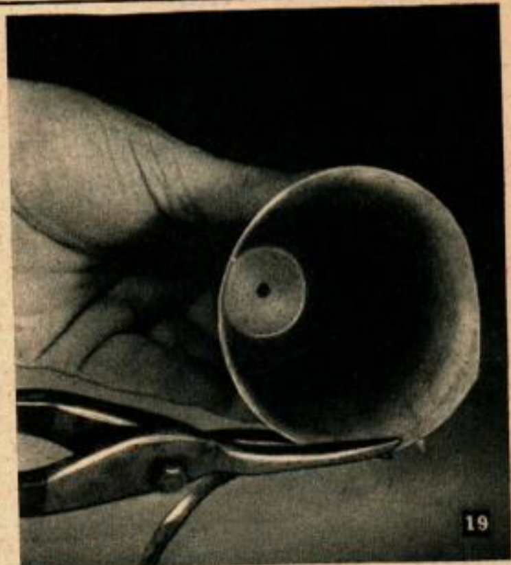
Les repoussages profonds donnent lieu à un allongement du métal. Couper l'excédent à la cisaille avant de passer à l'étape suivante.
