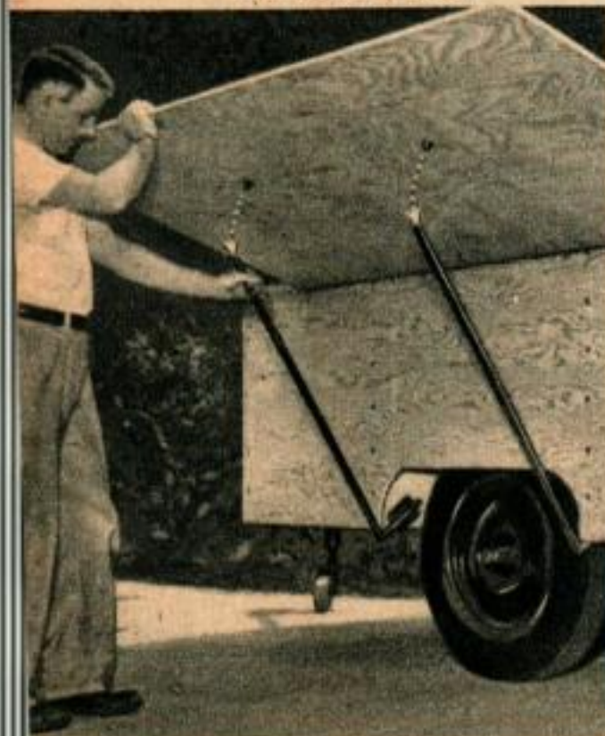
Ci-dessous, on rabat le couvercle sur les supports obliques. Ces derniers viennent buter contre des têtes de boulons solidaires du couvercle — détail ci-dessus à droite.
