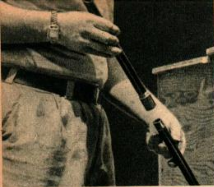
Des prolongateurs tubulaires sont visés sur les supports des couvercles pour augmenter leur longueur.
