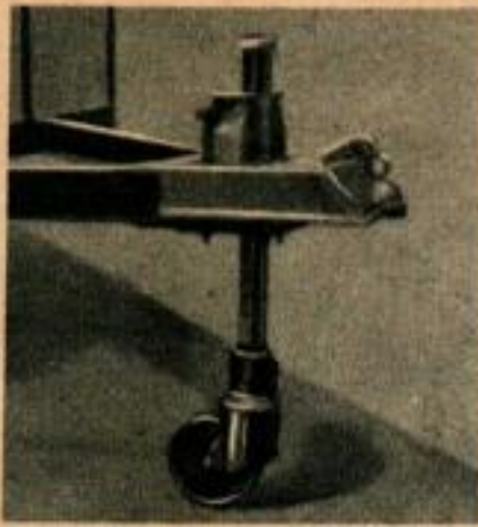
On utilise à l'avant une roulette orientable du commerce du modèle courant pour remorques, qui se fixe sur une plaquette soudée à l'avant du timon. Ceci permet un déplacement facile de la remorque.
