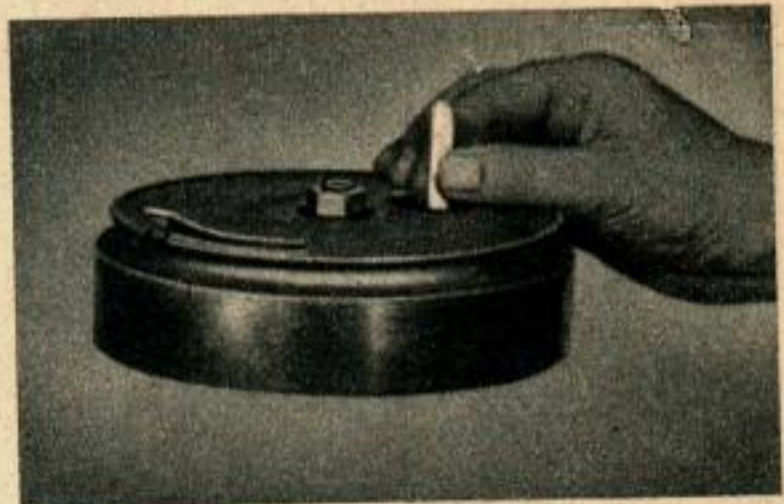
Les points du rupteur sont écartés avec une lame de tournevis et nettoyés en faisant monter et descendre lentement entre les points un grattoir spécialement construit pour cet usage. Terminer par l'essuyage des contacts en remplaçant le grattoir par une feuille de papier déplacée de la même manière.
