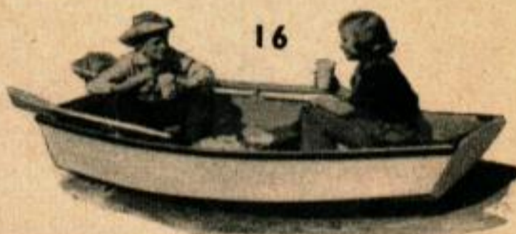
16. Bateau pour enfants, de 2,45 m (8 ft.), pesant seulement 28 kg (62 lbs.), les pièces de la charpente sont entièrement en acajou.
