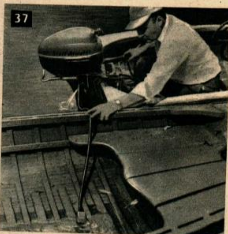
37. Le moteur Scott-Atwater a une pompe d'écopage automatique qui fonctionne sans arrêt pendant la marche du moteur.
