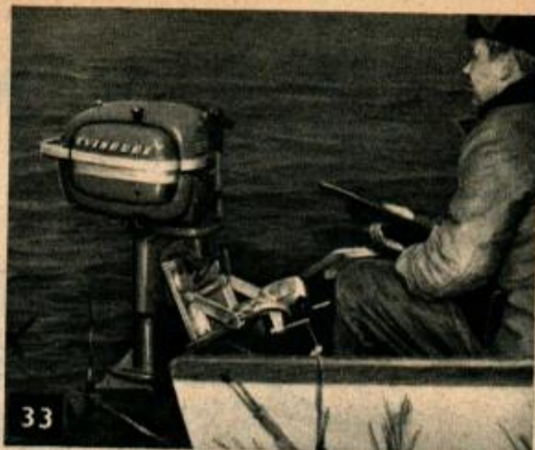
33. Le bâti du moteur comporte une manivelle qui permet de le monter et de le descendre de 17,5 cm (7 in.) afin que l'hélice soit convenablement immergée, quelle que soit la charge du bateau.
