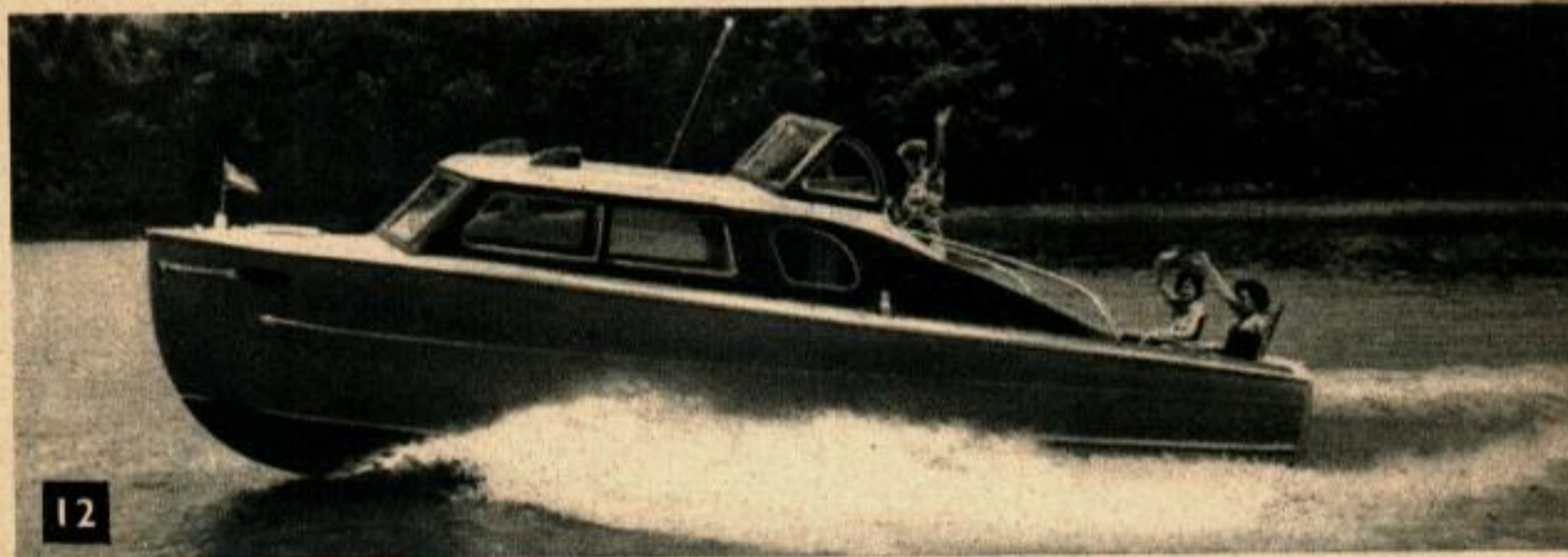
12. Type assez différent de bateau: le Flagliner Safti-Craft a une coque en acier soudé avec trois compartiments étanches.
