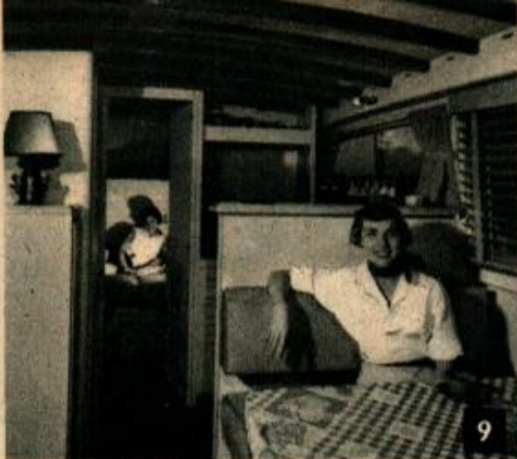
9. La salle à manger de ce bateau de 5,80 m (36 ft) peut recevoir quatre personnes et se transformer en chambre; les places assises se transformant en lit à deux places. Au total, six personnes peuvent coucher dans cette embarcation.
