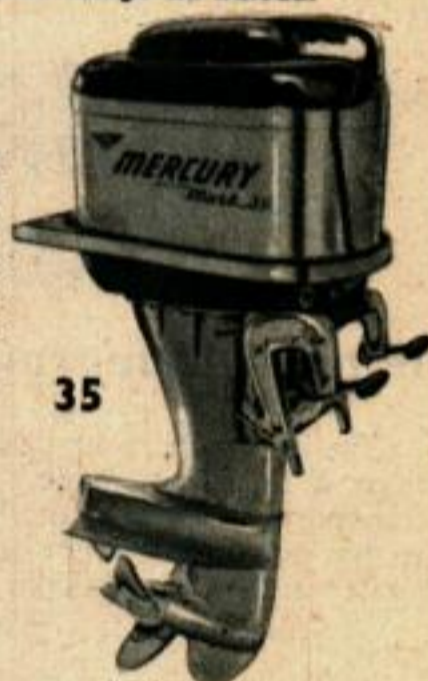
35. Le plus puissant moteur de hors-bord construit actuellement est le quatre cylindres Mercury, qui a une puissance nominale de plus de 40 CV.
