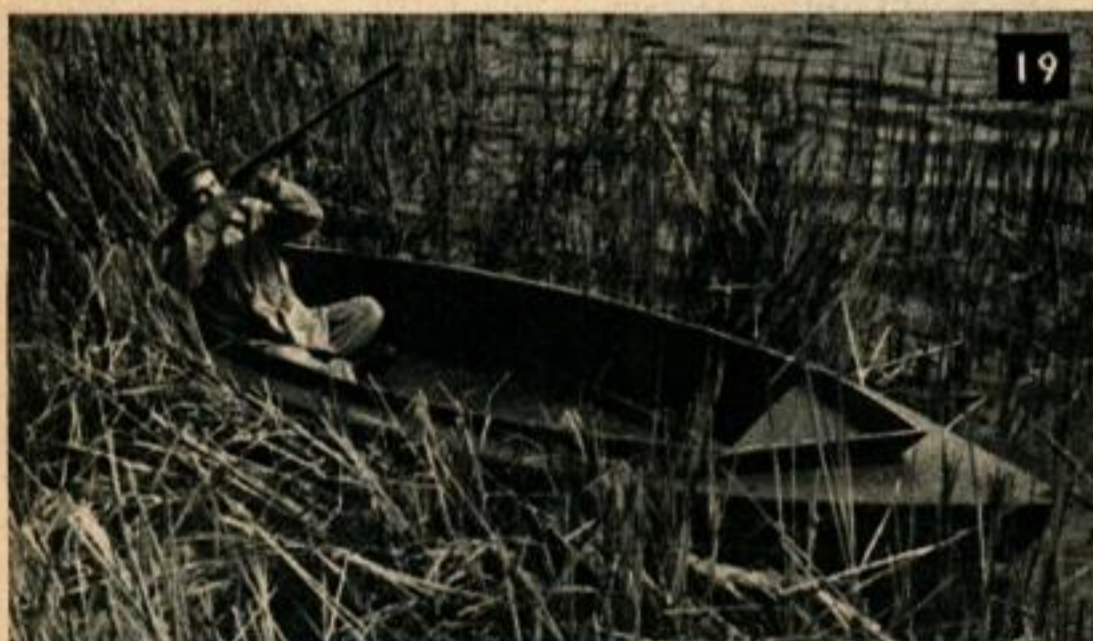
19. Canardière Chris-Craft de 4,25 m (14 ft.) entièrement vendue en pièces détachées, avec panneau arrière de forme spéciale permettant d'y adapter un moteur de hors-bord.
