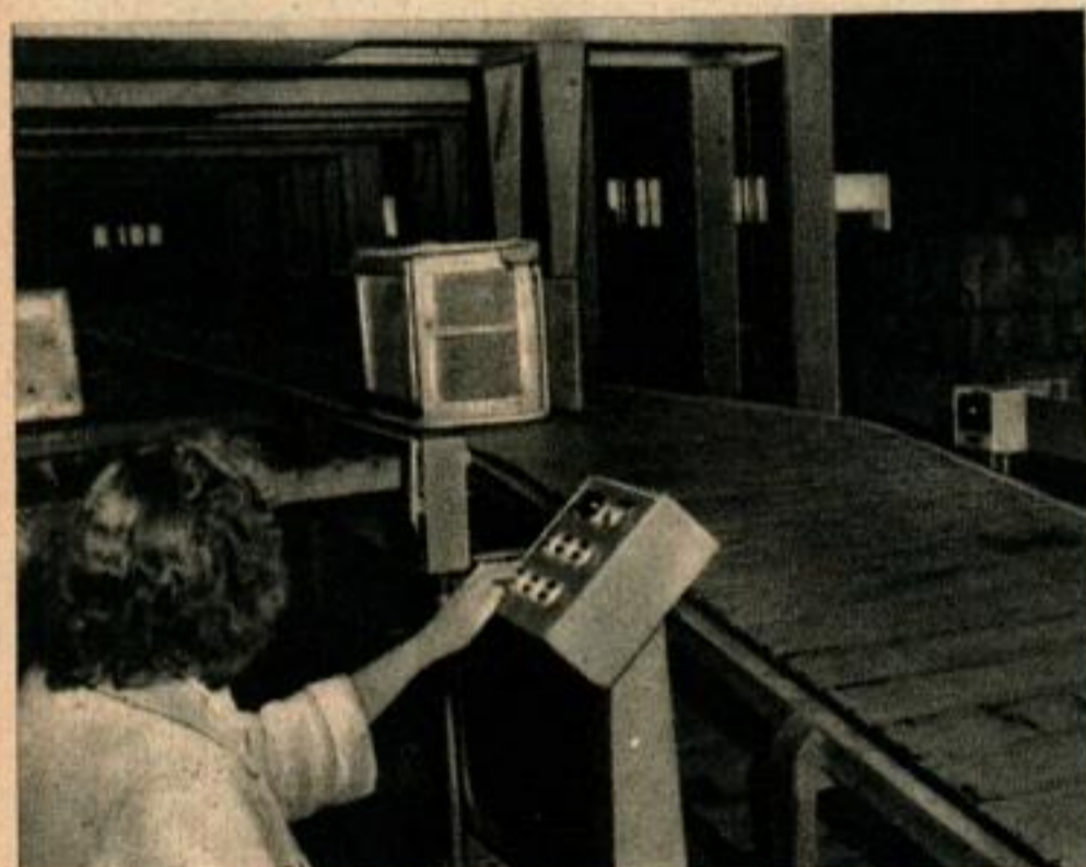
Les entrepôts de la Smama sont munis de tapis roulants où les colis sont triés et envoyés à destination au moyen d'appareils à cellules photo-électriques commandées par un clavier du genre de celui que représente la photo ci-dessus.
