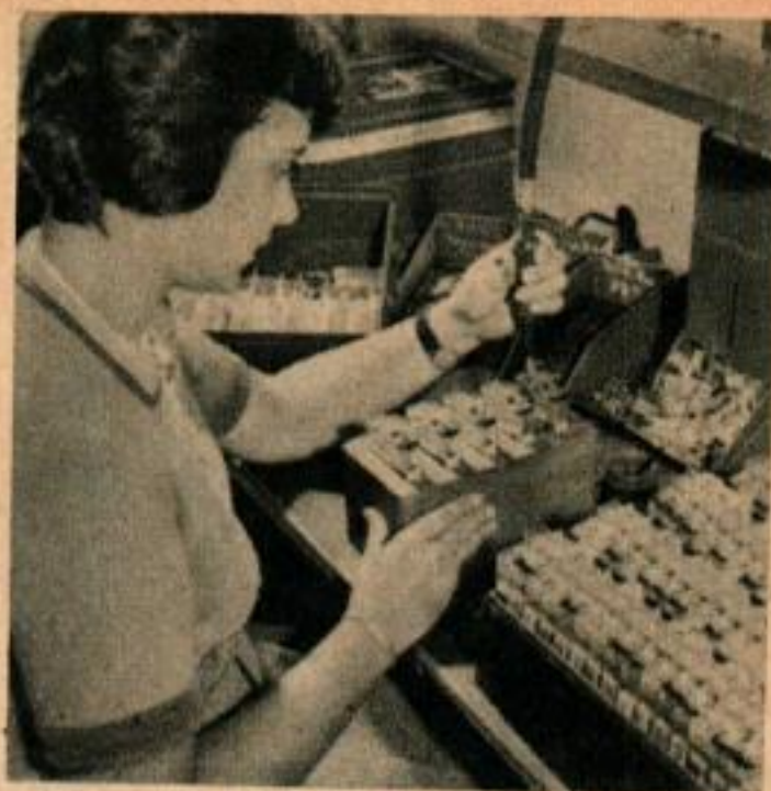
La construction industrielle de ces accumulateurs aux États-Unis est encore lente, parce qu'elle comporte trop de travail manuel. Chaque élément est renfermé dans une boîte en matière plastique transparente.
