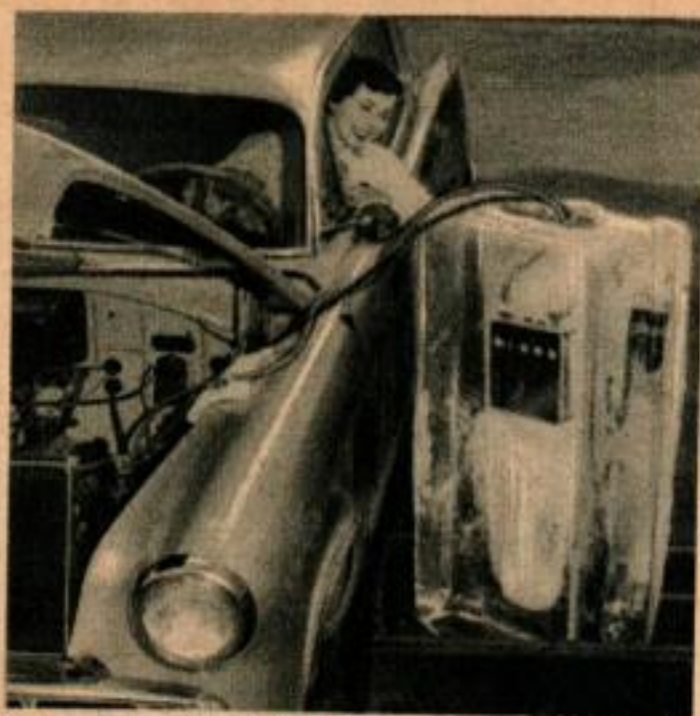
Les premières batteries d'accumulateurs au nickel-cadmium ne supportaient pas le froid intense. Le modèle ci-dessus à plaques frittées est enrobé dans un bloc de glace et fonctionne quand même; il assure un démarrage rapide de la voiture.
