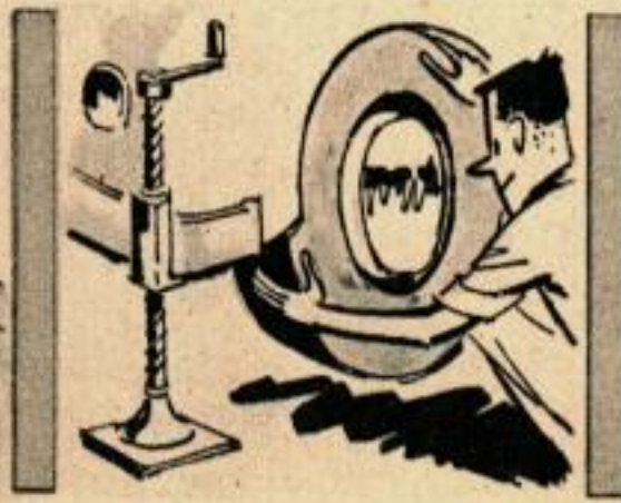
Permuter de temps à autre les pneus pour en égaliser l'usure et les fatigues qui se font surtout sentir sur la partie latérale de l'enveloppe.
