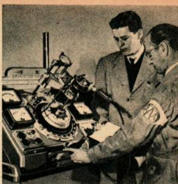
D'autres vérifient le fonctionnement de l'allumeur et le système d'avance à l'allumage. Les bougies doivent être conformes à un modèle rigoureusement défini et sont examinées pour voir si elles se trouvent effectivement dans les limites admises.
