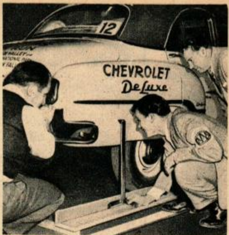
Mesure du niveau d'essence dans les réservoirs. A la fin du parcours, la voiture est mise exactement dans la même position qu'au début pour la mesure précise de la consommation.
