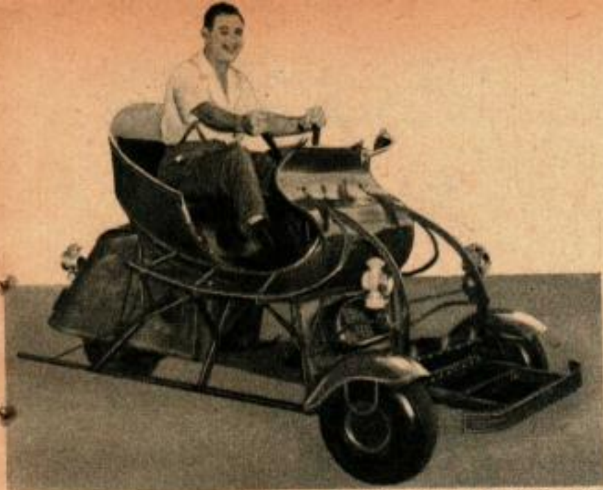
↑ Traineau qui n'a pas besoin de neige ou de glace pour se déplacer, car il a été monté sur un châssis de scooter à moteur. C'est un revendeur de pièces détachées pour automobiles qui l'a construit pour faire les livraisons en ville.
