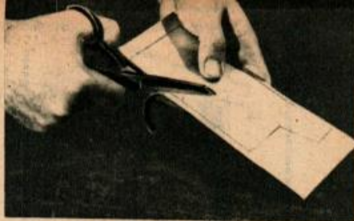
Une paire de ciseaux suffit pour couper les tôles d'aluminium qu'elles soient planes ou gaufrées, striées, etc.
