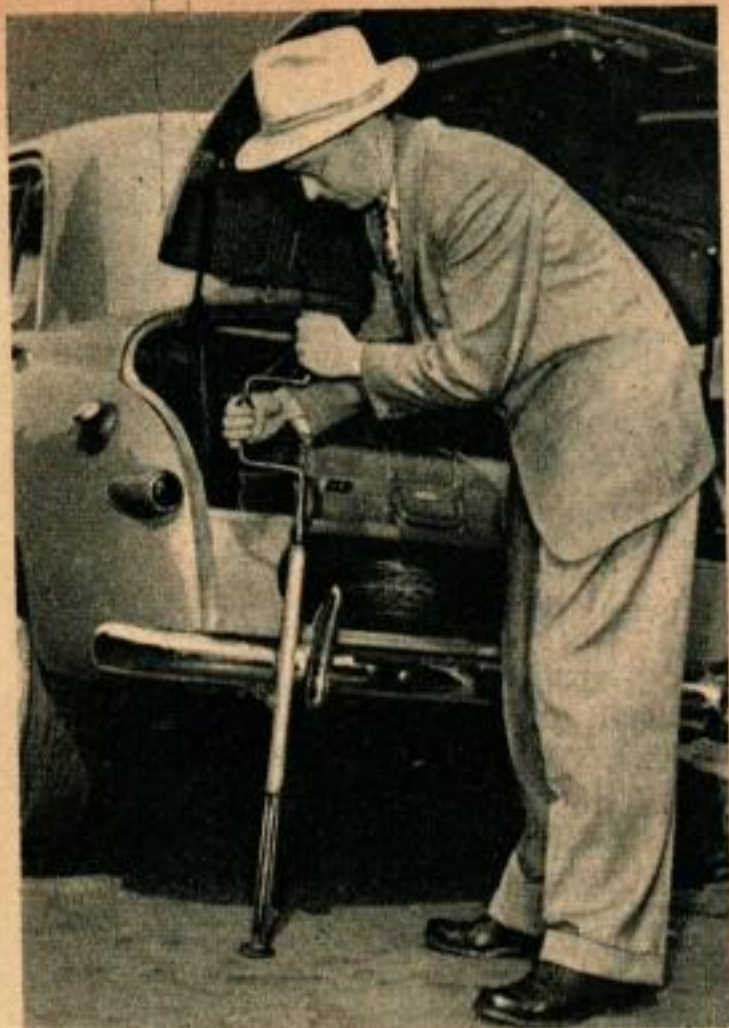
Le cric de la Hillman Minx est un vérin mécanique à colonne s'engageant dans des logements permanents fixés au châssis. Il offre toute sécurité, car il ne peut pas glisser.
