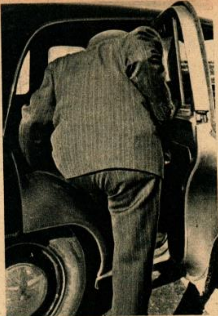
L'accès à la banquette arrière est assez difficile. La porte ne s'ouvre pas complètement, et la roue arrière gêne les mouvements.
