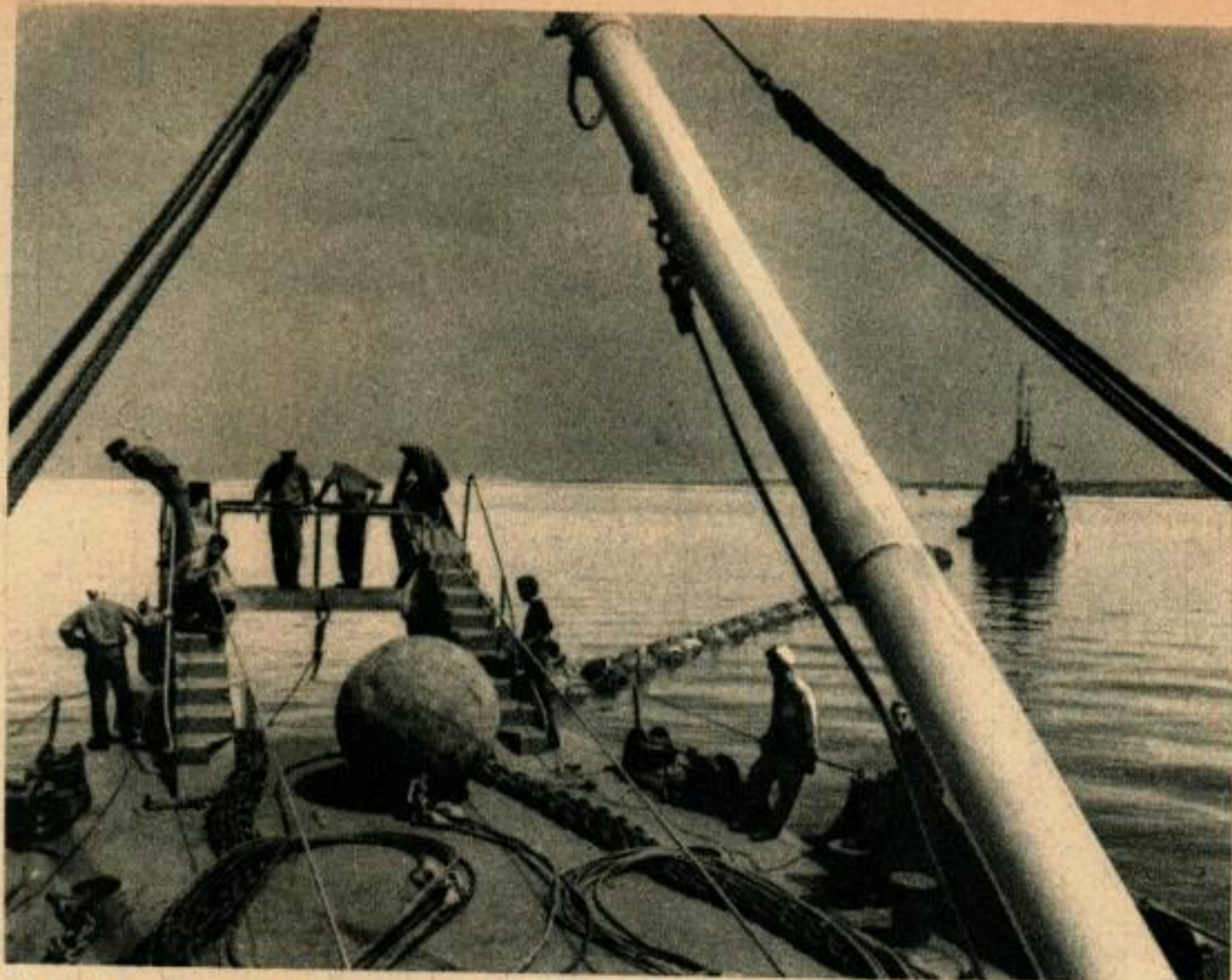
Le navire poseur de filets laisse tomber les filets et les bouées et un autre navire va remorquer l'ensemble du filet à l'emplacement prévu.
