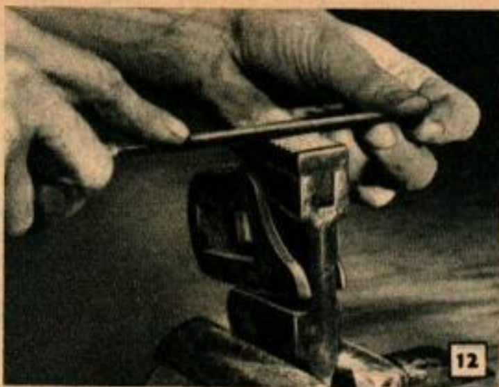
Les mâchoires des clés à tubes sont striées, ces stries peuvent se refaire à la lime en veillant à la régularité de la taille des dentures.
