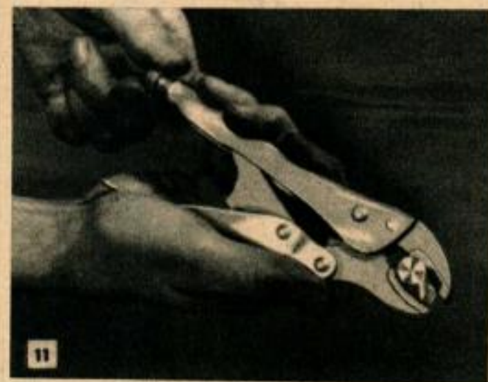
Clé à serrage parallèle ajustable à l'épaisseur de la pièce. En serrant les poignées on bloque la clé.
