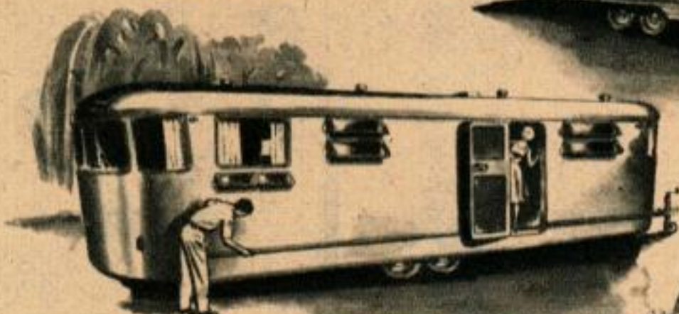
Ci-dessus, Spartan s'inspire des méthodes de l'aviation pour fabriquer une remorque solide et aérodynamique, avec de grandes baies vitrées à l'avant et à l'arrière. Les flancs sont en aluminium riveté.
