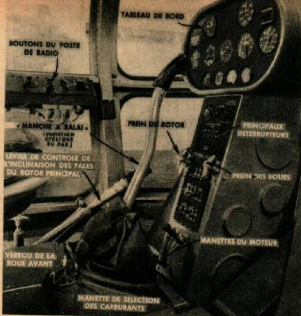
La principale différence entre un cockpit d'hélicoptère et celui d'un avion, c'est le deuxième manche à balai, à gauche du siège du pilote: la poignée permet de donner les gaz comme sur une moto.
