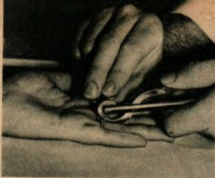
Cet instrument sert à scier les bagues. L'opérateur tourne la scie circulaire de la main droite, tandis que de la main gauche il règle la pression exercée par la scie sur la bague. Le doigt est protégé par une petite plaque métallique.
