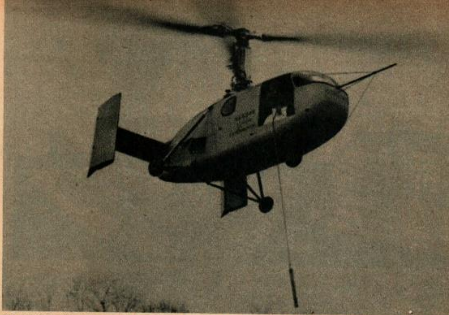
Le scintillomètre est suspendu à un câble de façon à effleurer le sol et ne capter que les radiations directes.
