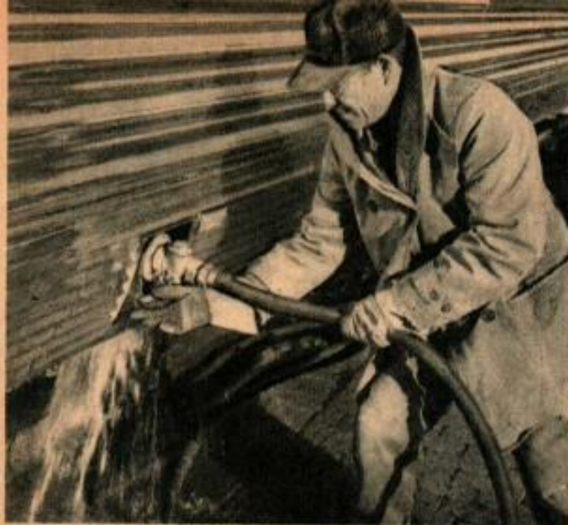
Un train de douze voitures consomme 7.500 litres d'eau potable. Chaque voiture a son propre réservoir.
