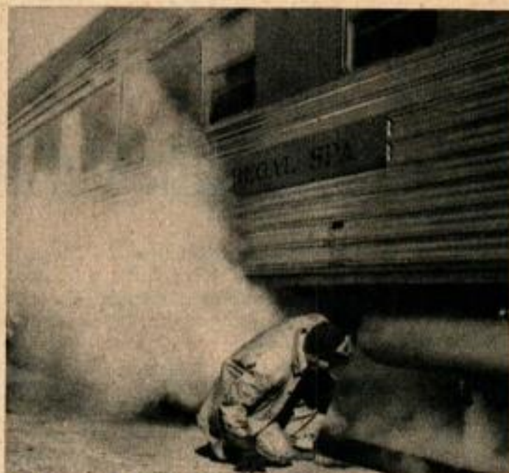
On examine également les robinets du système de conditionnement d'air qui laissent échapper de la vapeur lorsque la voiture est arrêtée. Ci-dessous, on vérifie à la main la température des boîtes d'essieux.
