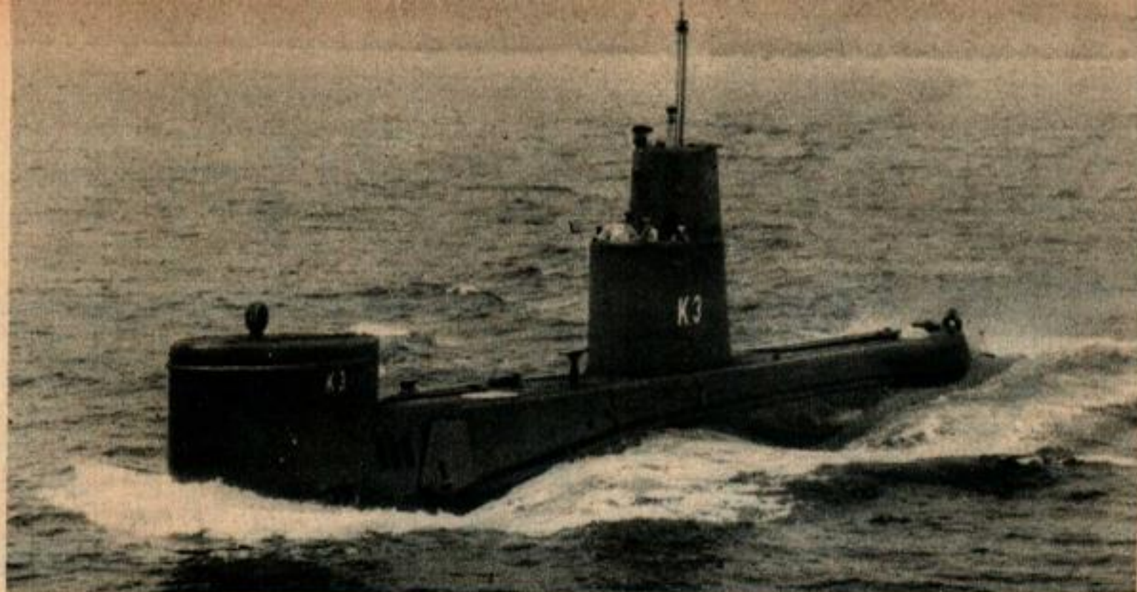
L'étrave massive de ce «tueur» conçu pour lutter contre les autres sous-marins, comprend un équipement secret de sonar, à longue distance.
