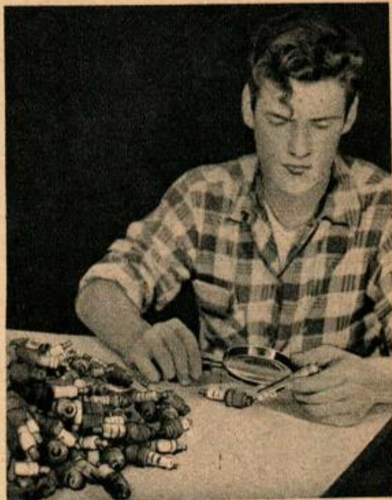
Sans avoir besoin de regarder un moteur, le garagiste expérimenté apprend beaucoup de choses en examinant les bougies et peut décrire les conditions de fonctionnement de chacun des cylindres.
