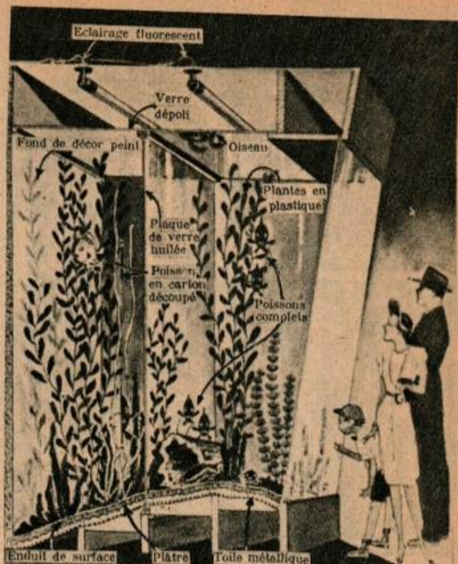
Le dessin montre comment des plaques de verre donnent l'illusion de profondeur à la scène ci-dessous. Les poissons sont en bois de balsa.
