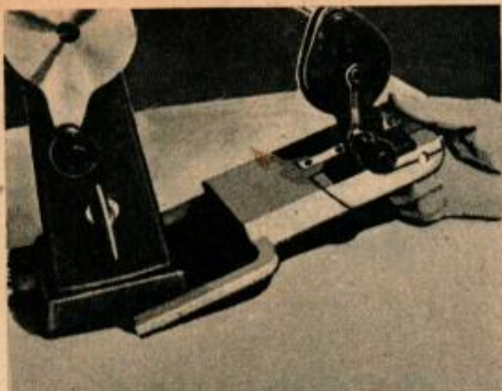
Montage de la visionneuse sur le support contenant le système d'enroulement des films. Une fois placée, la visionneuse est dans sa position correcte et reste stable sur le support.
