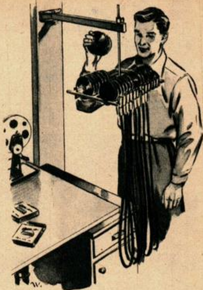
Le râtelier porte quatre ensembles de six bobines et il est suspendu par une tige à un levier orientable fixé au mur.
