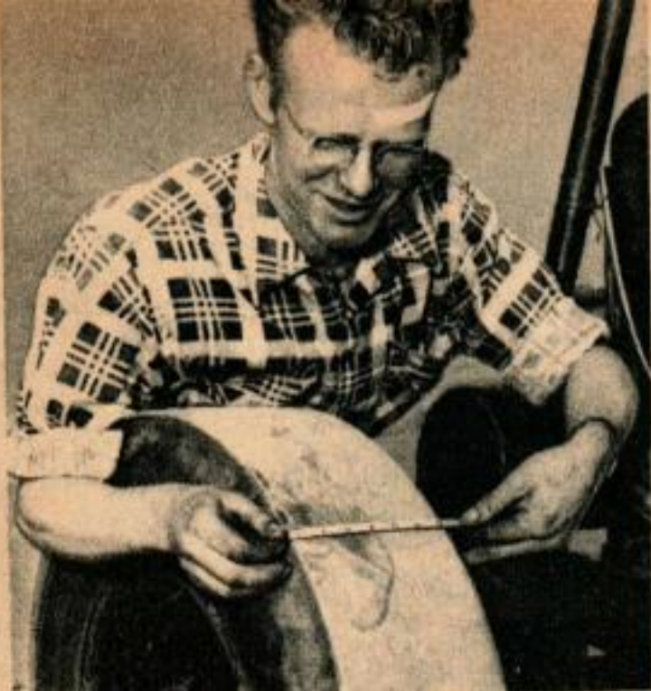
Les pneus arrière — des « asphalt slicks » en américain — ont une grande adhérence assurant une excellente traction: la surface de contact avec le sol a presque 18 cm de large.
