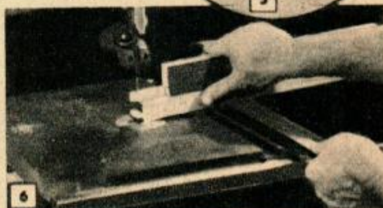
Le pare-éclats est façonné sans démontage.
