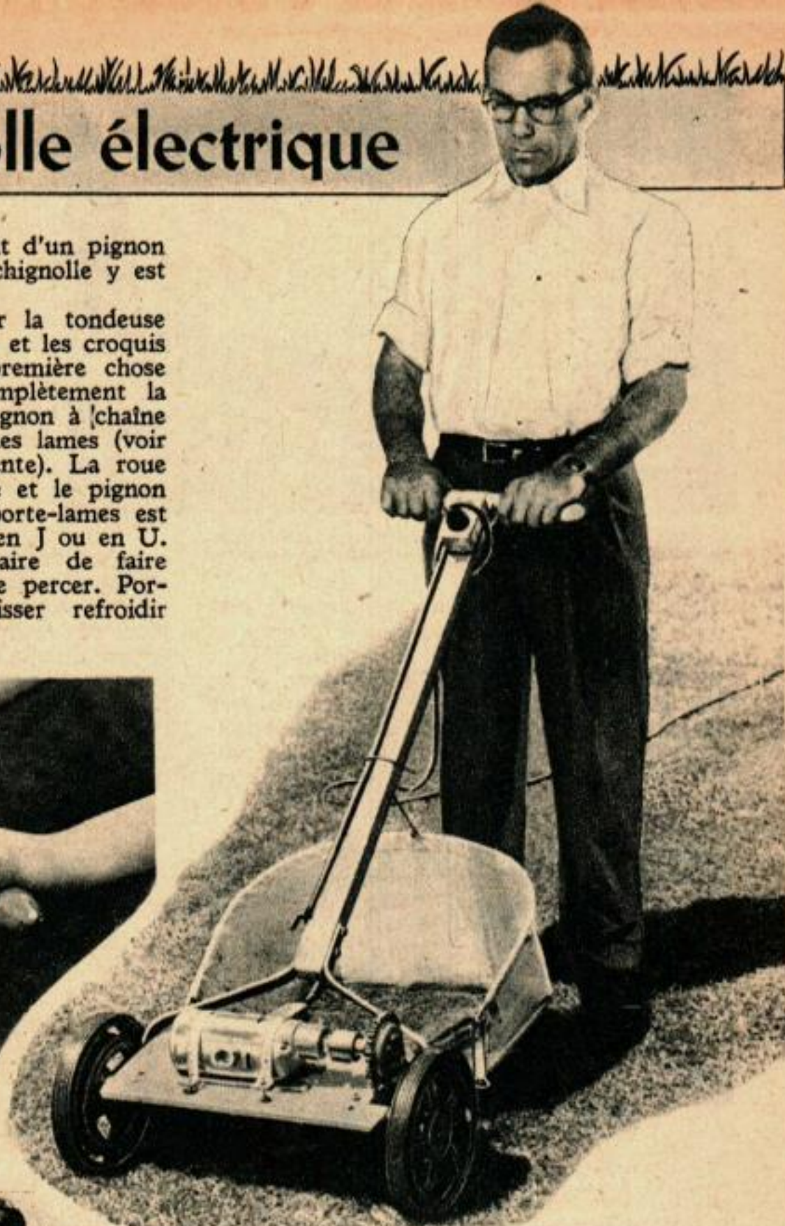
Le moteur est commandé par un interrupteur monté sur une boîte recevant également une prise de courant et qui est fixée sur le manche.
