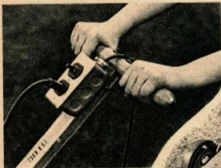
Le moteur est commandé par un interrupteur monté sur une boîte recevant également une prise de courant et qui est fixée sur le manche.
